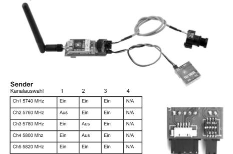
**WARNUNG:** Schalten Sie den Empfänger nicht ohne montierte Antenne ein, da dieses den Verstärker zerstört. Der kleine weisse Anschluss auf der Rückseite des Sender ist für den Immersion RC Tiny Telemetrieanschluss.
